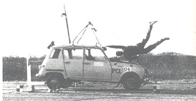
Instantánea captando un choque experimental de un atropello. Ref. D. CESAR y CABALLERO. Revue de l'INRETS (Recherche, Transport, Sécurité) n° 9-10, junio 1986.
